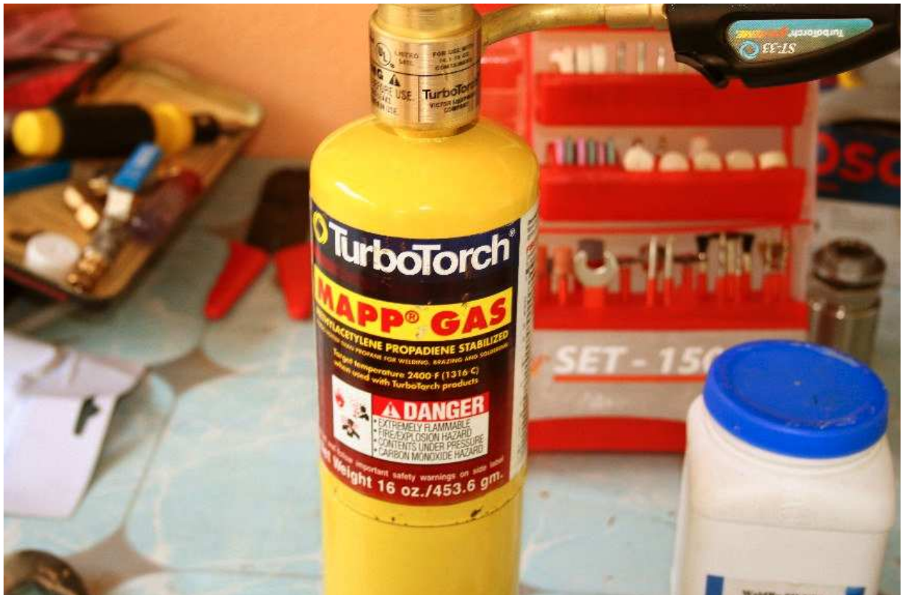
Vous aurez besoin de MAPP un chalumeau au gaz pour obtenir la chaleur nécessaire pour le brasage à l'argent
