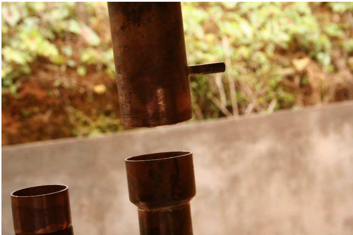
Vous remarquerez que j'ai utilisé un raccord 2" sur le récepteur de sorte que le condenseur s'emboite de manière très précise.
