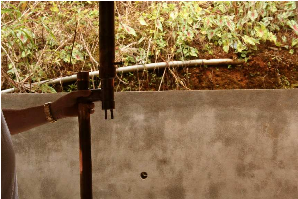
Emboitage du condenseur dans la tête de l'alambic, un essai d'ajustement
