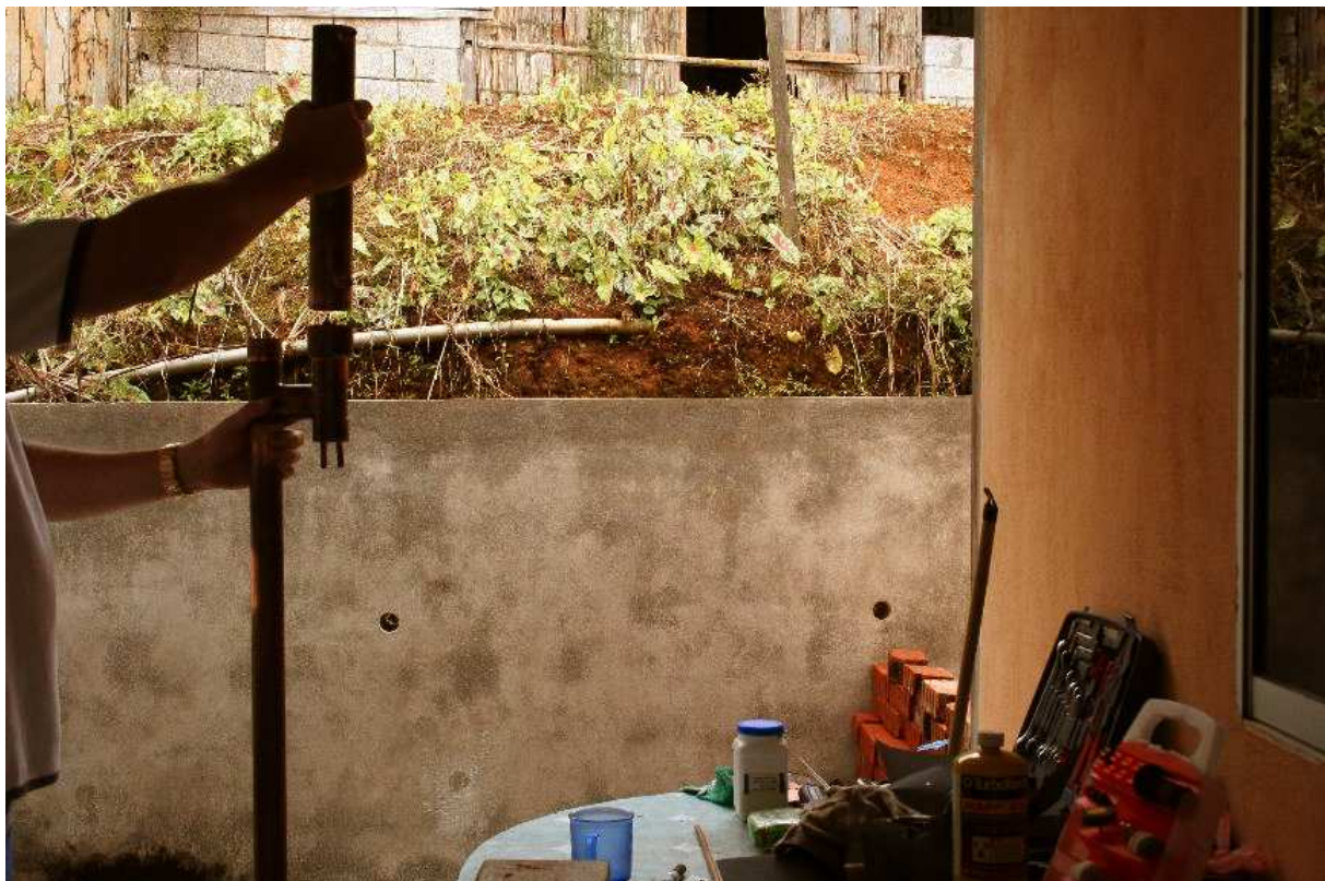
Le condenseur terminé avec ses connecteurs brasés, dans l'attente du nettoyage.
