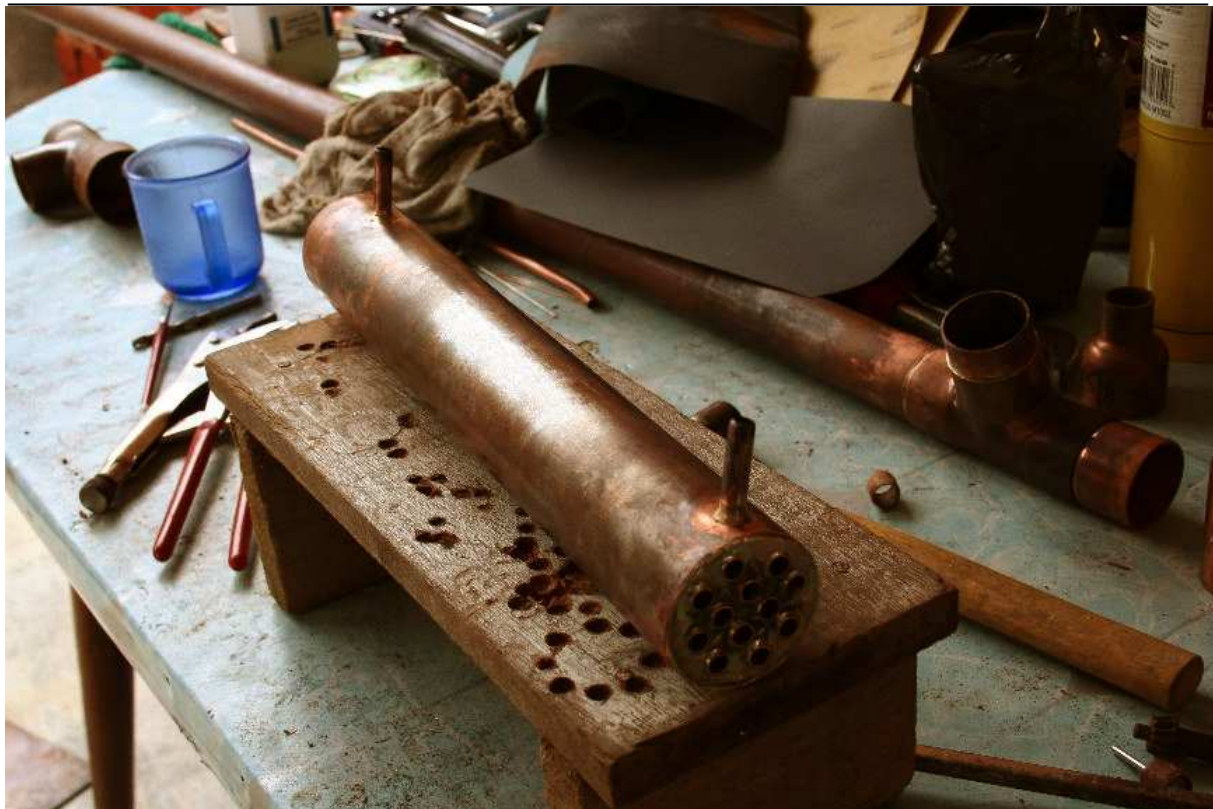
Le condenseur terminé avec ses connecteurs brasés, dans l'attente du nettoyage.
