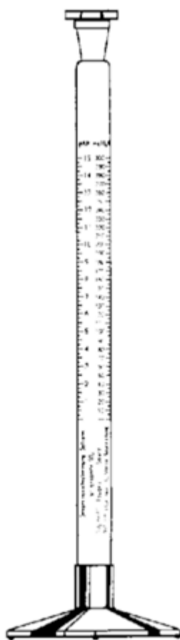
fig. 52 : éprouvette Titrovin pour le dosage de l'acidité totale titrable
