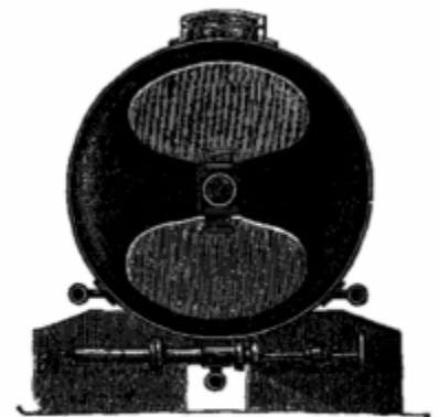
Fig. 41. — Agitateur et réfrigérant combinés de l'appareil de Bohm.
